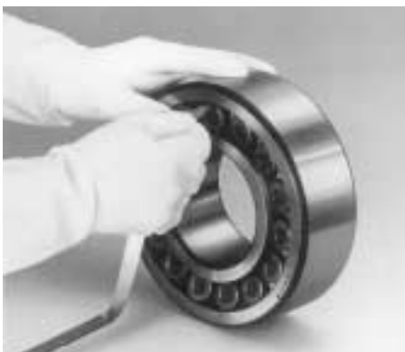
Figura 1 - Medição de Folga no Rolamento Autocompensador de Rolos
