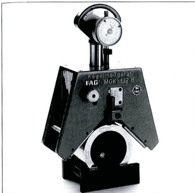
12: O aparelho para medição de conicidade FAG MGK 132 é apropriado para comprimentos de cone a partir de 80 mm e diâmetros do cone entre 90 e 820 mm.
